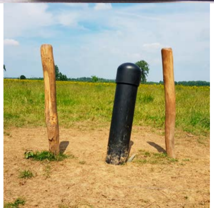
Enkele van de geplaatste peilbuizen zijn vanaf de dijk goed zichtbaar.
